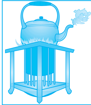
Gambar 4.14 Pemanasan air dalam ketel terjadi secara konduksi dan konveksi
