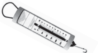
Gambar 4.2 Neraca pegas yang digunakan untuk mengukur gaya.
