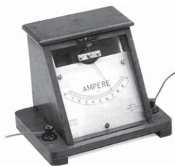
Gambar 1.16 Amperemeter untuk mengukur kuat arus.
