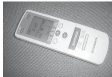
Gambar 8.6 Remote kontrol menggunakan sinar infra merah.
