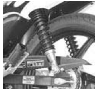
Gambar 3.3 Suspensi sepeda motor dipasang paralel
